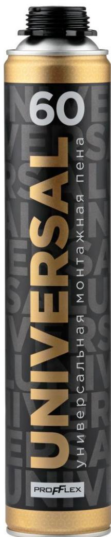
**UNIVERSAL 60** – профессиональная универсальная однокомпонентная полиуретановая пена, предназначенная для работы в диапазоне температур от -18°C до +35°C. Выход пены – до 60 литров. Наилучшие результаты достигаются при применении пены при температуре не ниже -12°C.
